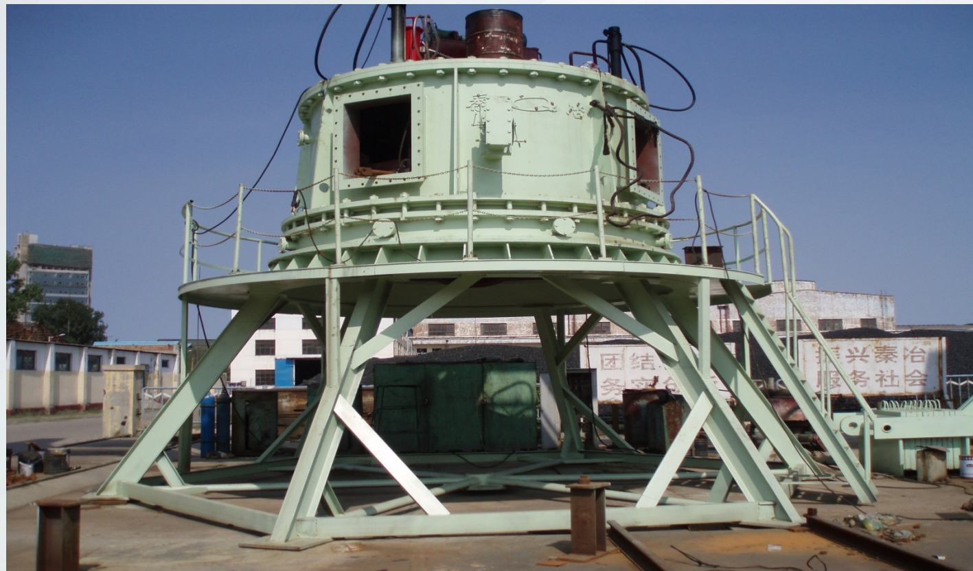
某高炉炉顶多环布料控制系统 采用数字液压技术
