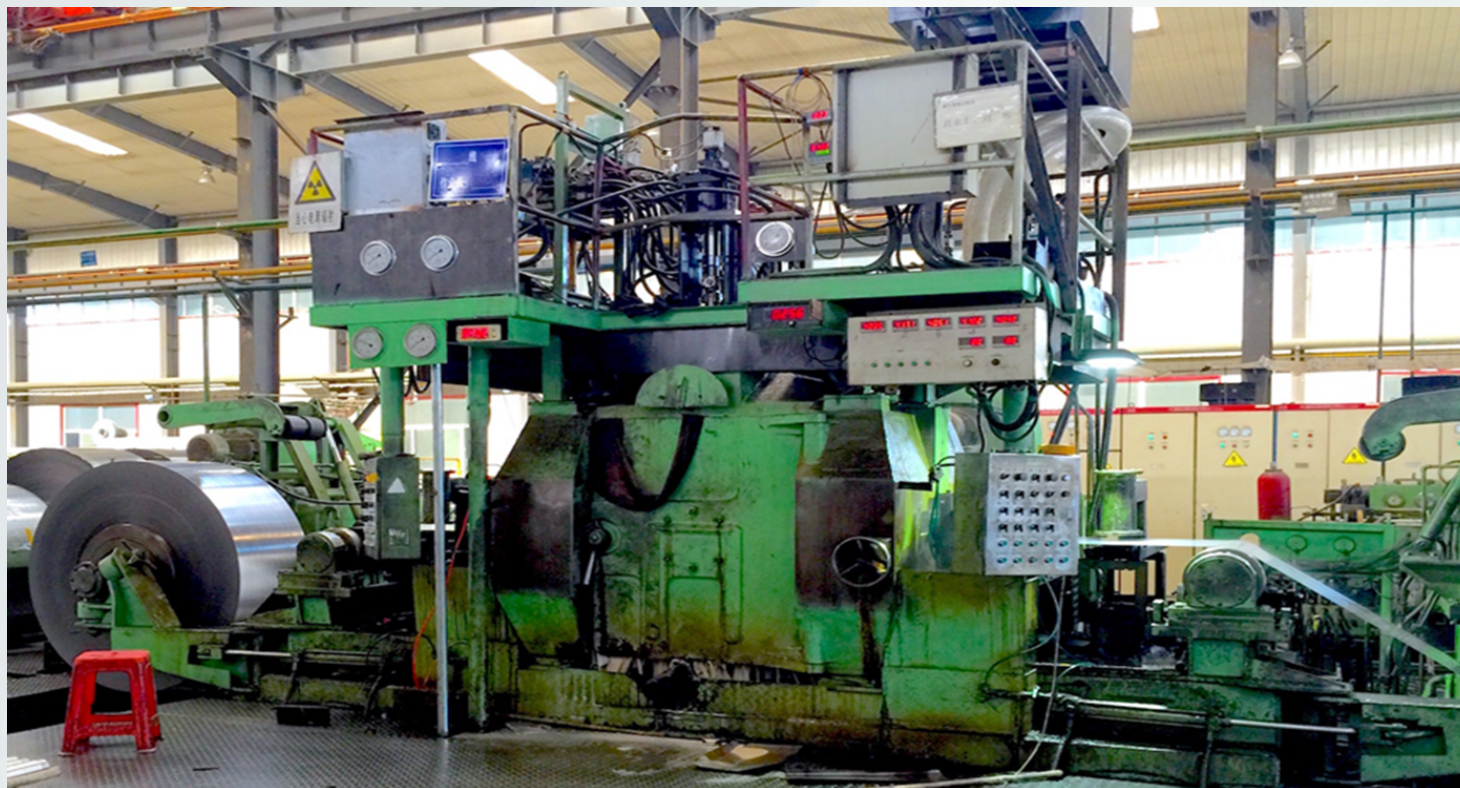
采用数字液压技术的20辊取向硅钢轧机AGC现场
